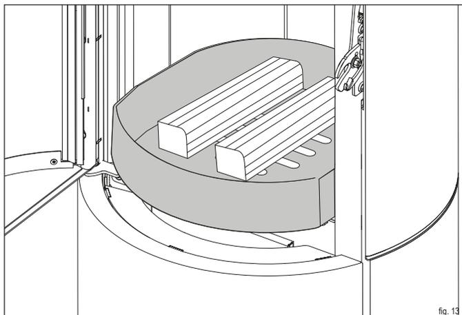
Durante l'apertura dello sportello della camera di combustione, l'indicatore di aggiunta di combustibile si spegne e il sistema di controllo regola automaticamente al meglio la valvola dell'aria.
