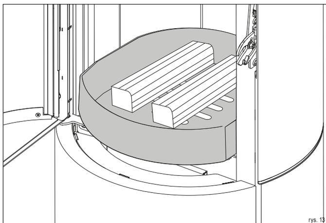
Po otwarciu drzwi komory spalania gaśnie wskaźnik dokładania, a system regulacyjny automatycznie dokonuje możliwie najlepszego ustawienia przepustnicy powietrza.
