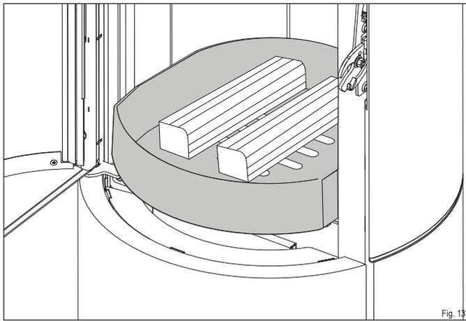
Lorsque la porte du foyer est ouverte, l'indicateur de remplissage s'éteint et le système de contrôle ajuste automatiquement le volets d'air au meilleur réglage possible.
