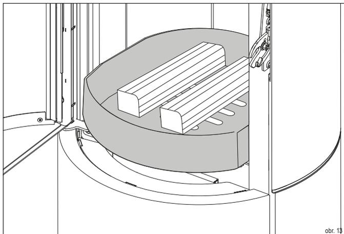
Při otevření dvířek od topeniště zhasne kontrolka pro přiložení a regulace provede automaticky nejlepší nastavení vzduchové klapky.
