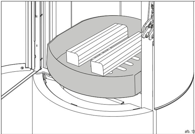
Wanneer de kacheldeur wordt geopend, gaat het bijvul-lampje uit en stelt het regelsysteem de luchtkleppen automatisch in op de meest ideale stand.
